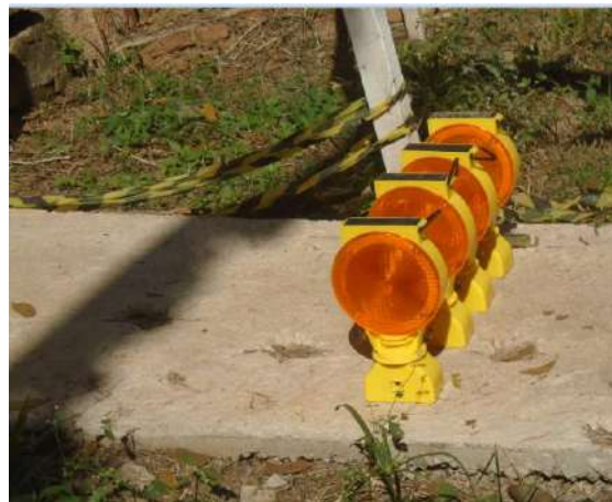
Sinalizadores com utilização de placas de energia solar.
